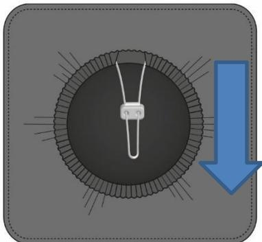
Um den Bezug zu entfernen, ziehen Sie das Blockiersystem in Pfeilrichtung vom Bezug weg, bis keine Spannung mehr im Gummizug vorhanden ist.
