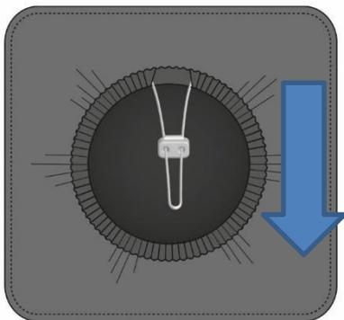
Um den Bezug zu entfernen, ziehen Sie das Blockiersystem in Pfeilrichtung vom Bezug weg, bis keine Spannung mehr im Gummizug vorhanden ist.
