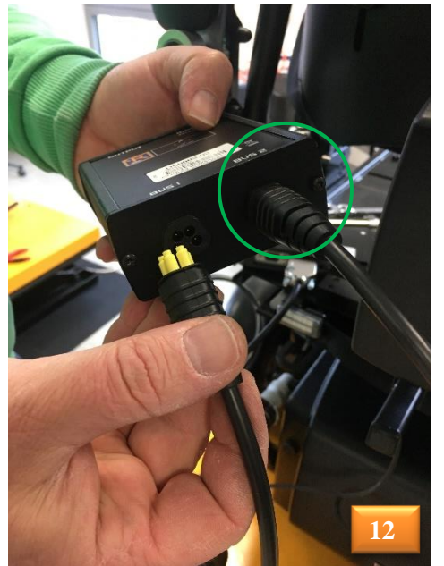
Schließen Sie das Kabel zur Stromversorgung an den Verteilersockel des Elektrorollstuhles an ( Abb. 11 ) und verbinden Sie das Kabel mit dem BUS 2 Anschluß des Elektronikmoduls (siehe Abb. 12 grüner Kreis).
