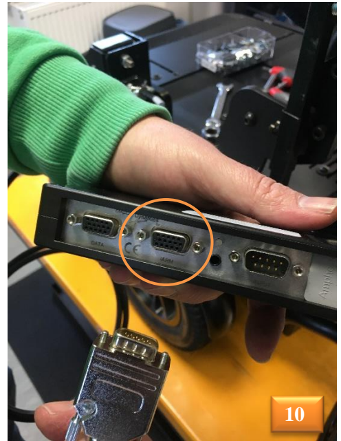
Schließen Sie das Hauptkabel an der Lifteinheit ( Abb. 9 ) und an der Anschlußbuchse "iARM" am I-/O-Modul an ( Abb. 10 ).
