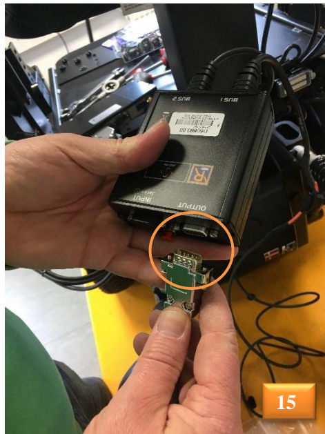
Schließen Sie das Interfacekabel am "Output" Anschluß des Elektronikmoduls an (Abb. 15) und verbinden Sie es mit dem "Input" Anschluß des I/O-Moduls (Abb. 16).
