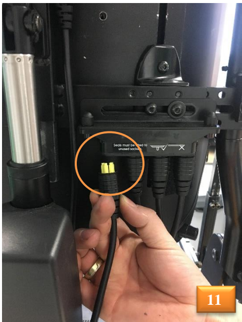
Schließen Sie das Kabel zur Stromversorgung an den Verteilersockel des Elektrorollstuhles an ( Abb. 11 ) und verbinden Sie das Kabel mit dem BUS 2 Anschluß des Elektronikmoduls (siehe Abb. 12 grüner Kreis).
