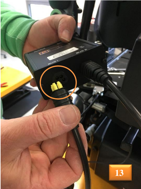
Verbinden Sie das Kabel zur Stromversorgung mit dem BUS 1 Anschluß des Elektronikmoduls (Abb. 13) und dem "Power" Anschluß des I/O-Moduls (Abb. 14).
